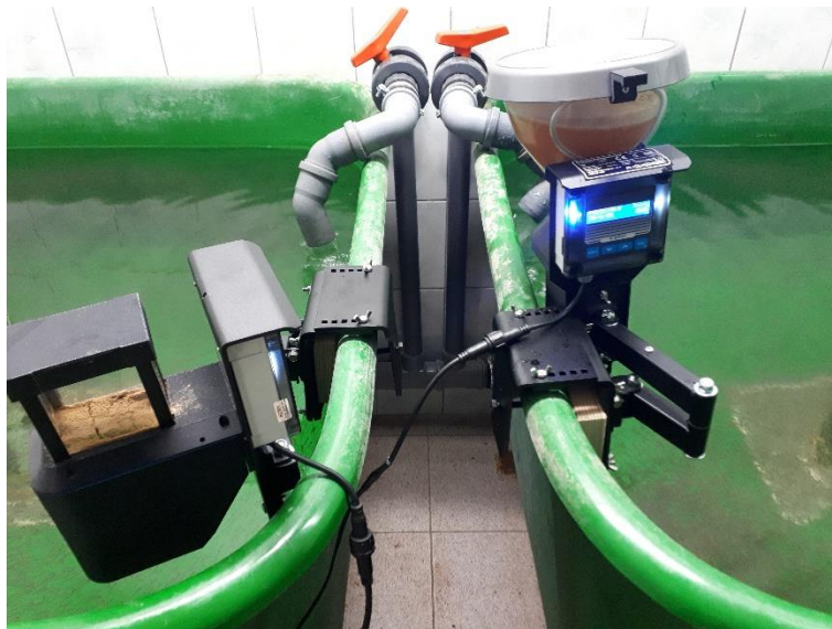
Fot. 9. Karmnik do zadawania żywych naupliusów solowca (z prawej strony).
