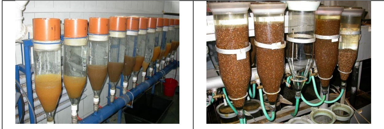
Fot. 4. Różne sposoby umieszczenia zaworów doprowadzających wodę do aparatów Weissa.
