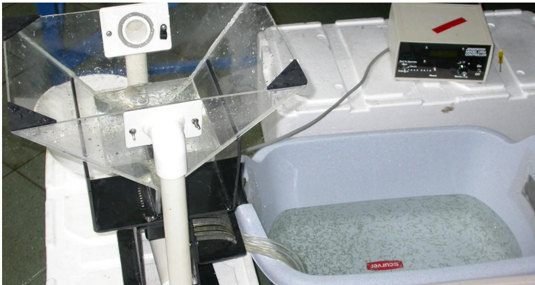
Fot. 8. Odliczanie wylęgu siei licznikiem elektronicznym.
