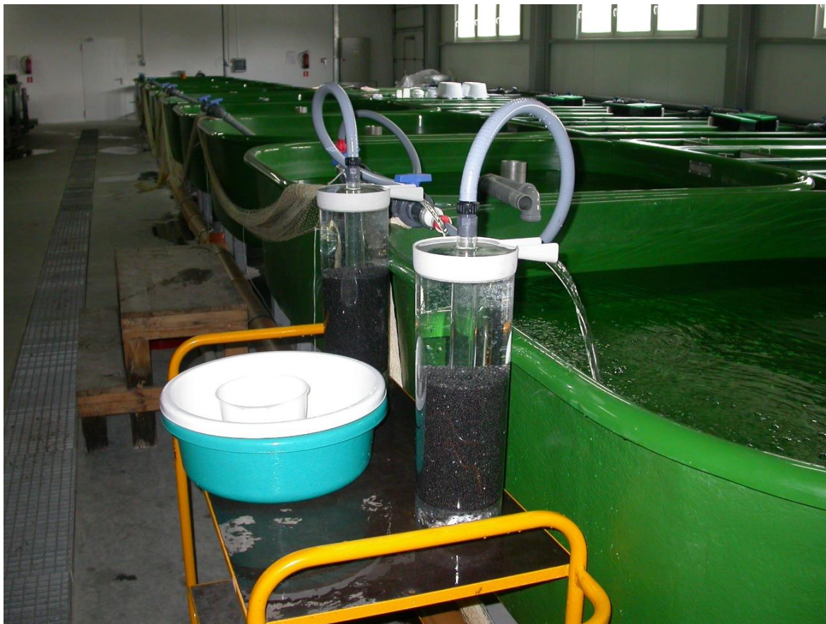
Fot. 7. Przenośne aparaty inkubacyjne do wykluwania ryb w basenie podchowowym.
