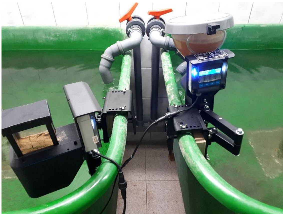
Fot. 4. Karmnik do zadawania żywych naupliusów solowca (z prawej strony).
