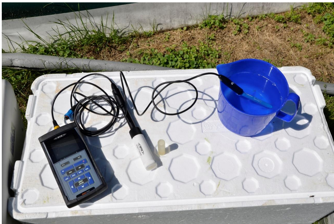
Fot. 5. Przykładowe urządzenie do pomiaru nasycenia wody tlenem (tlenomierz) i jej odczynu (pehametr).
