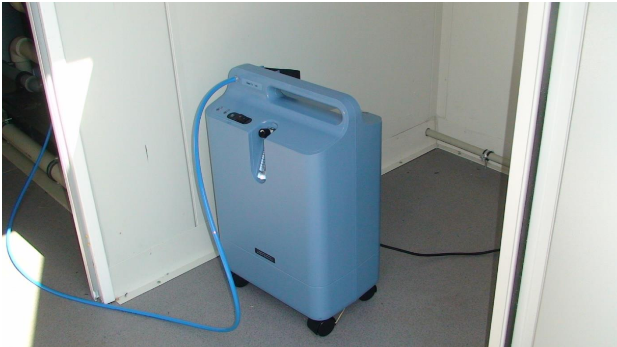
Fot. 2. Koncentrator tlenu wykorzystywany do natlenienia wody w RAS (fot. E. Ulikowska).
