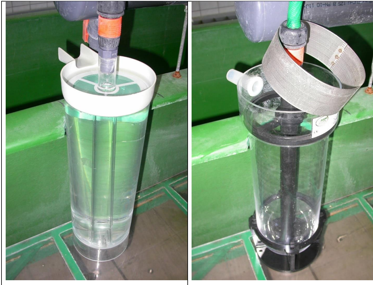
Fot. 2. Aparat inkubacyjny typu Mc Donalda (z lewej) i Falko (z prawej).
