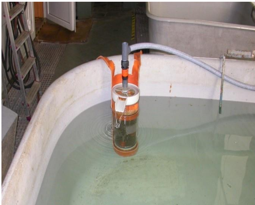
Fot. 7. Przenośny aparat inkubacyjny służący do wykluwania larw w basenie podchowowym.
