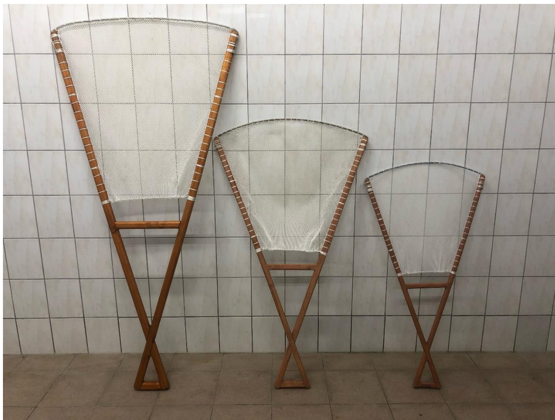
Fot. 4. Sufaty o różnych rozmiarach zalecane do manipulacji na tarlakach suma (fot. M. Kozłowski).
