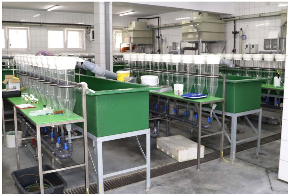
Fot. 3. Aparaty inkubacyjne recyrkulacyjnego systemu akwakulturowego do inkubacji ikry i podnoszenia wylęgu szczupaka (Zakład Rybacki Janowo, Okręg Mazowiecki PZW w Warszawie).
