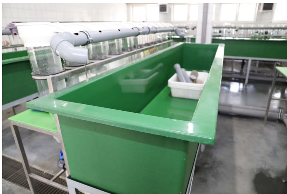
Fot. 4. Odbieralnik recyrkulacyjnego systemu akwakulturowego do inkubacji ikry i podnoszenia wylęgu szczupaka (Zakład Rybacki Janowo, Okręg Mazowiecki PZW w Warszawie).
