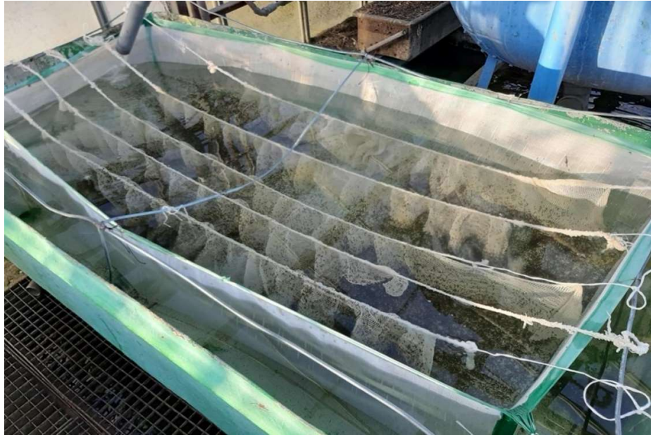
Fot. 9. Przykład odbieralnika wykonanego z laminatu poliestrowo-szklanego.
