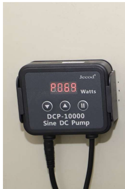
Fot. 13. Pompa obiegowa oraz kontroler służący do regulacji wydajności pompy.
