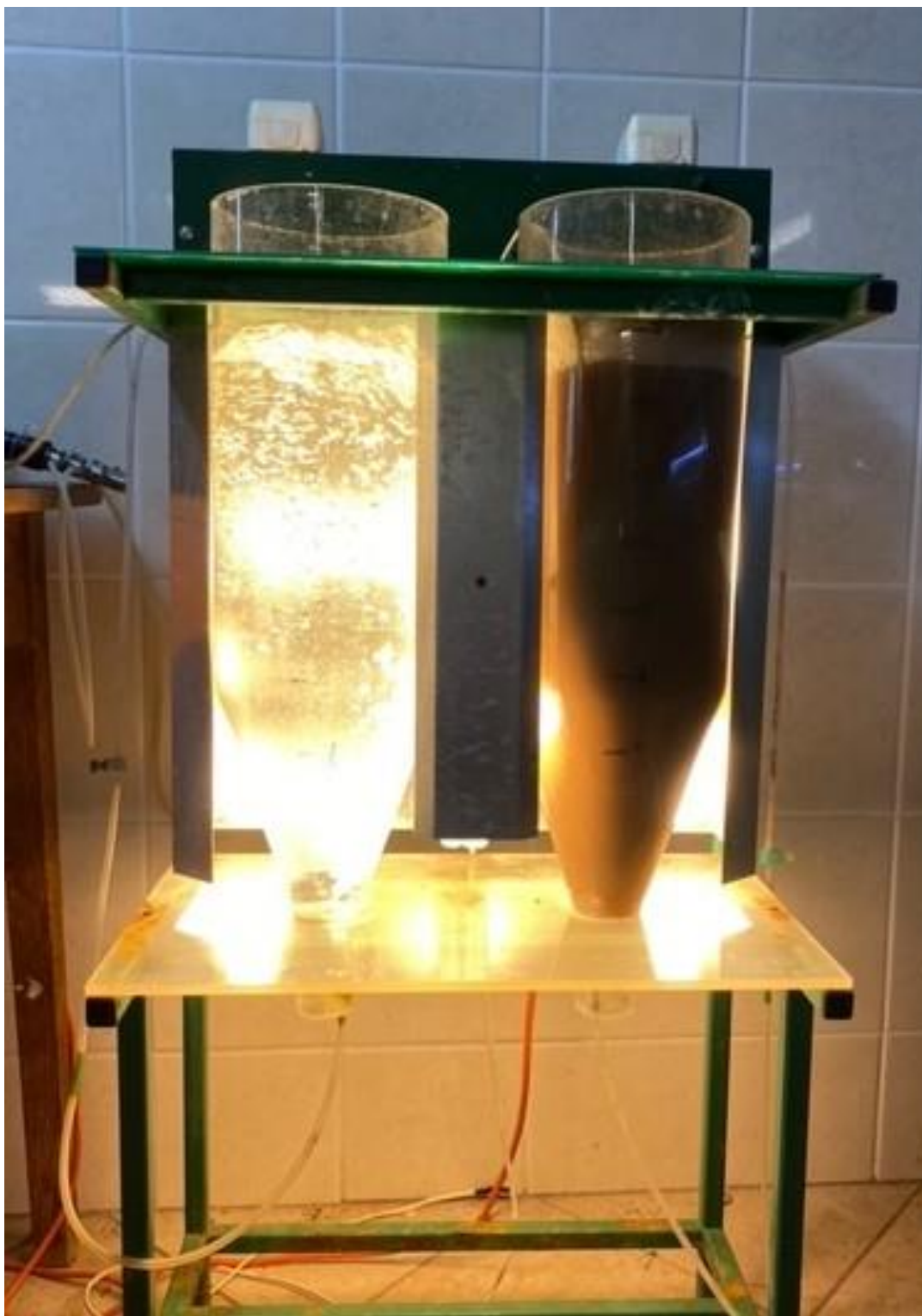
Fot. 6. Profesjonalny system do inkubacji artemii ze słojami o objętości 7 l (fot. J. Sikorska).
