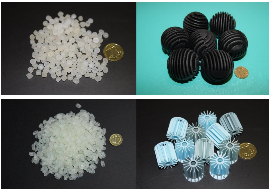
Fot. 1. Przykłady kształtek wykorzystywanych do wypełniania biofiltrów
