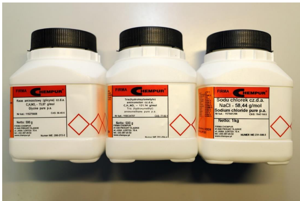
Fot. 9. Zestaw odczynników do sporządzenia płynu Bollarda.
