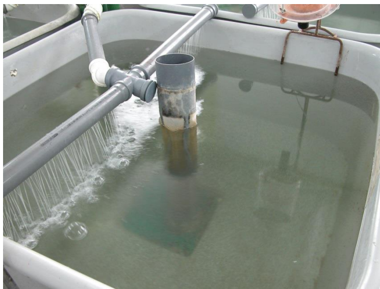
Fot. 7. System zraszający wodę w basenach do podchowu larw sandacza (fot. Z. Zakęś).
