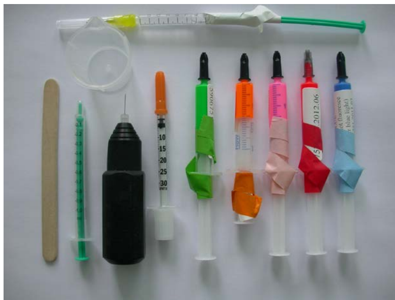
Fot. 6. Zestaw do znakowania ryb elastomerami. Od prawej: 5 strzykawk z różnymi kolorami elastomeru, utwardzacz i aplikator (fot. M. Szczepkowski).
