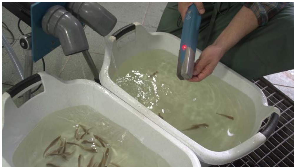
Fot. 5. Sprawdzanie obecności znacznka CWT w ciele ryby za pomocą ręcznego detektora. Obecność znacznka potwierdza świecąca się czerwona dioda (fot. A. Smoczyński)
